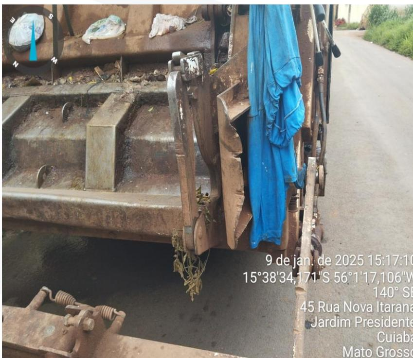
**Bordas do compartimento de carga amassadas, com risco de cortes e fraturas para o colaborador**
