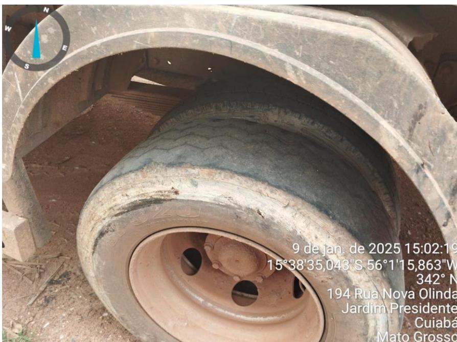
**Pneus com desgaste excessivo, aumentando o risco de acidentes.**
