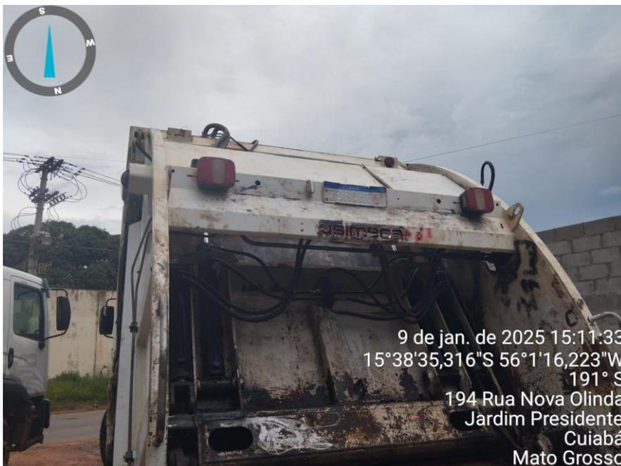
**Caminhão sem giroflex item de segurança que garante a visibilidade do veículo, especialmente durante a realização de operações em vias públicas. instalado no topo do caminhão.**
