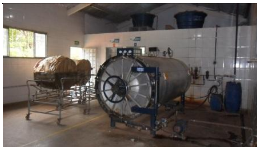
Foto 27: Autoclave usada no tratamento dos RSSS
